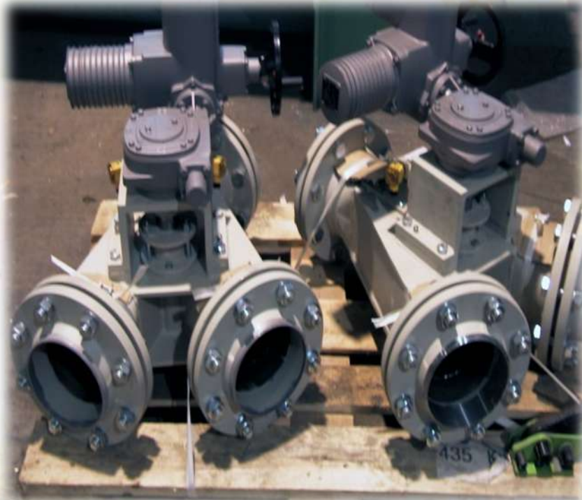
Umstellweichen für Rohrleitungen mit pneumatischem Stellantrieb
